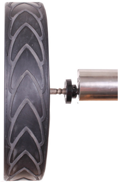
Rückansicht Rad – Freilauf für den Betrieb ohne Motor (Motoren drehen nicht mit) werden die Räder um eine Raste auf der Achse vorgesetzt
